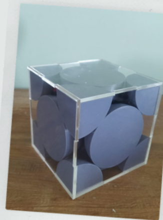
ESTRUTURA CRISTALINA CFC
